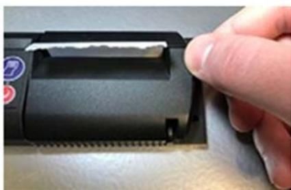
6 - Imprima um talão de teste para verificar se o rolo de papel está devidamente instalado
